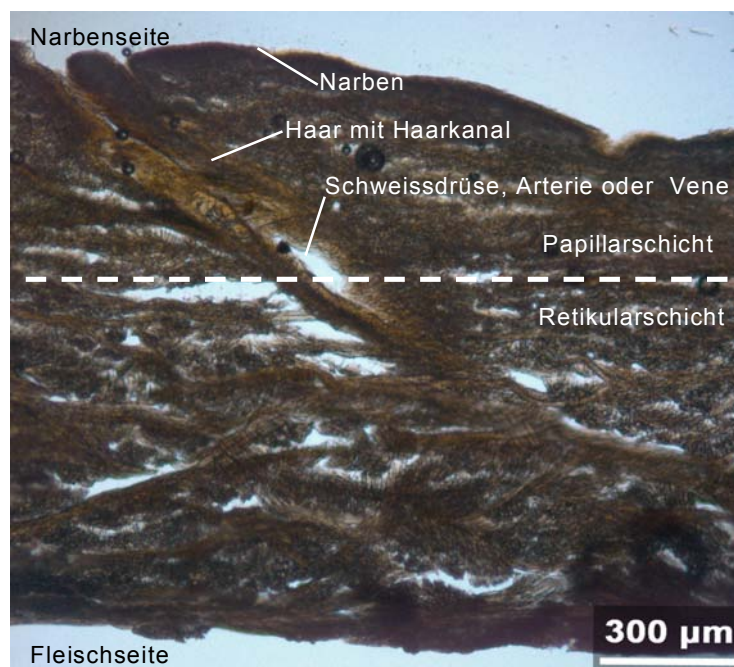
Abbildung 19: 30µm dicker, ungefärbter Gefriermikrotomschnitt des Probenleders in demineralisiertem Wasser (Durchlicht, Hellfeld, 50fache Vergrösserung)
