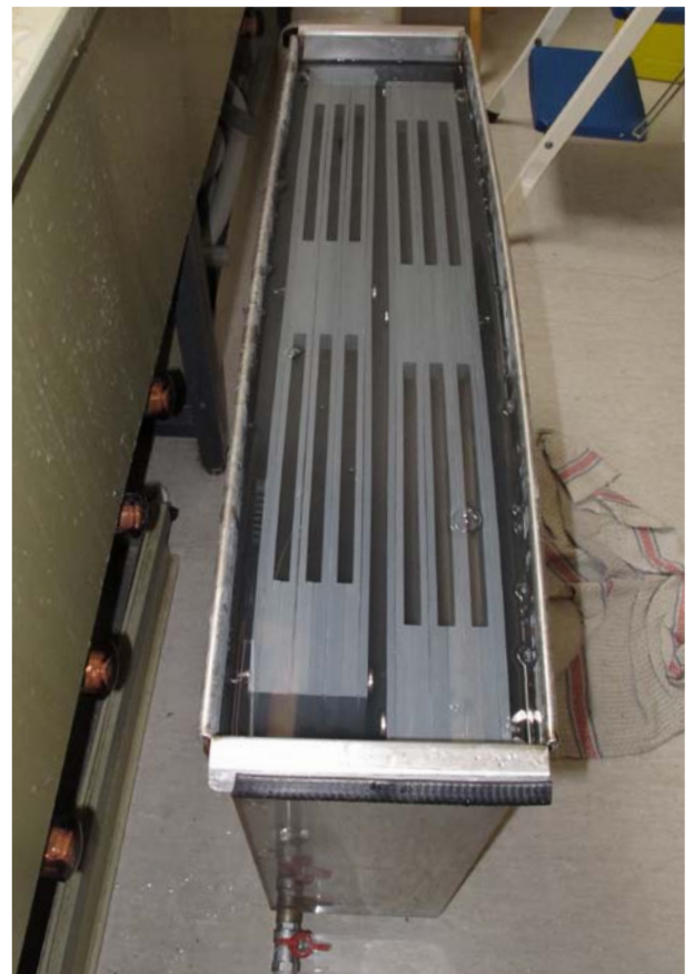
in Arbeit: Die Behandlung in Phytinsäure, anschliessend Auswaschen in 4 Bäder mit aufgetriebenem Wasser.
