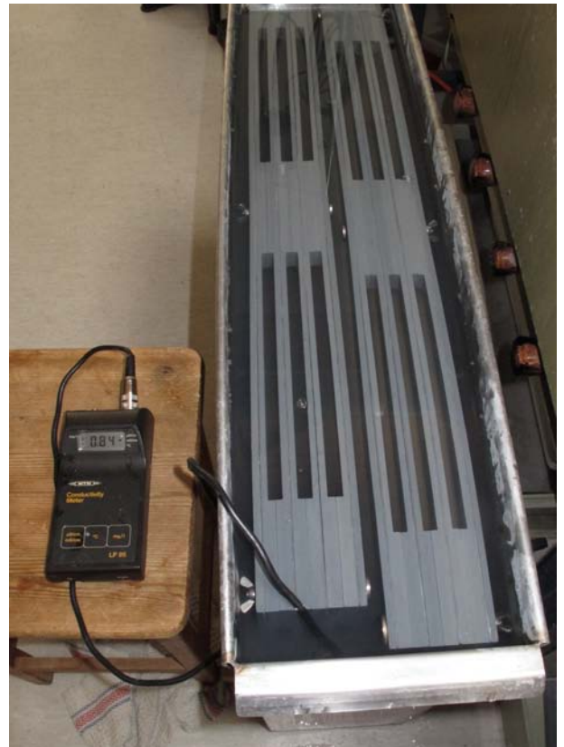
in Arbeit: Wässern in demineralisiertem Wasser, bis der Leitfähigkeitswert nicht weiter ansteigt. Dies bedeutet, dass alle löslichen Mineralien und Eisen-II-Ionen ausgespült wurden.
