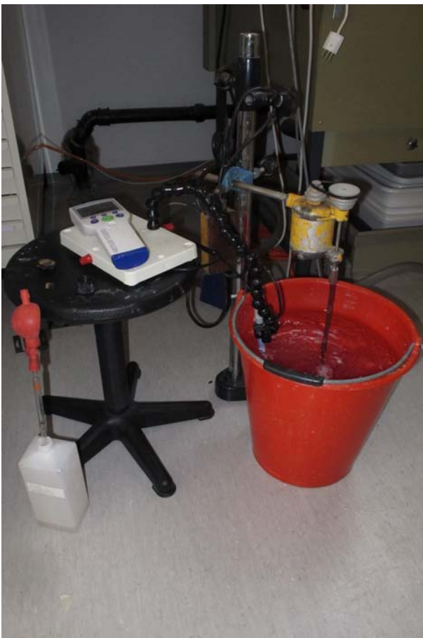
in Arbeit: Anheben des pH-Wertes der Phytinsäure mit Hilfe von Ammoniak.
