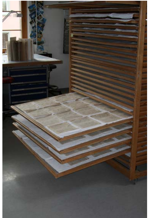
in Arbeit: Die Blätter trocknen nach dem Wässern und dem Leimen.
