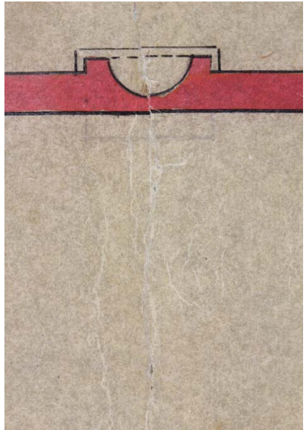
nachher: Vorderseite: Die Brüche wurden auf der Rückseite des Plans mit Japanpapier geschlossen
