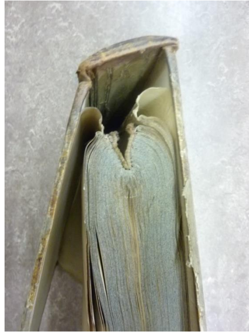
Bild 4 Durch das Absinken des Buchblocks ist dieser aus dem Einband gerissen und stark deformiert.
