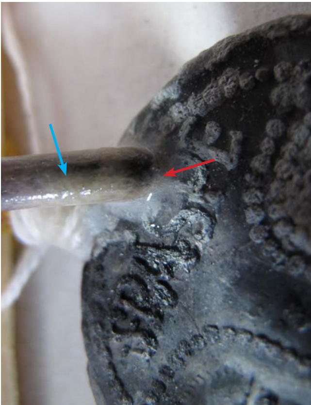
in Arbeit Reduzierung der Bleikorrosion; graue Klammer als Kathode, Platinelektrode (blauer Pfeil) wird in 1 Tropfen 0.1 molare Schwefelsäure gehalten. Durch den Strom entstehen fortlaufend Bläschen (roter Pfeil). Das weisse Bleicarbonat wird reduziert.
