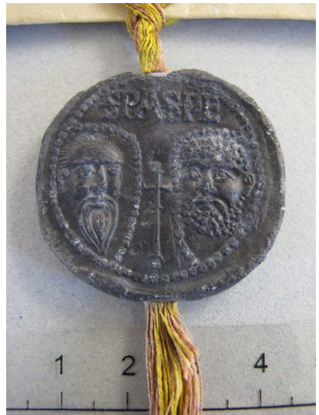
nachher Bleibulle der Urkunde A 7 recto: Die Bleibulle des Papstes ist vom basisches Bleicarbonat gereinigt. Bei den weissen Stellen handelt es sich nicht mehr um Bleicarbonat. Schutzfaden oben und unten an der Siegelschnur (weiss) noch nicht entfernt.
