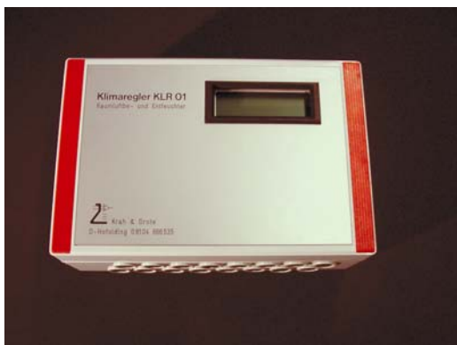
Abb. 1 Der Klimaregler KLR 01 nutzt die natürlichen wetterbedingten Schwankungen des Klimas der Umgebung, um durch intelligente Steuerung den Räumen Feuchtigkeit zu- oder abzuführen bzw. die Temperatur zu stabilisieren
