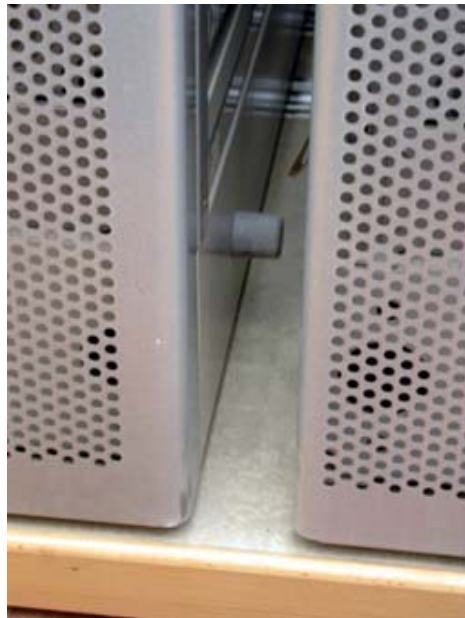
Abb. 4 Mit Stossdämpfern kann verhindert werden, dass Rollregale schließen und sich Mikroklimata bilden.
