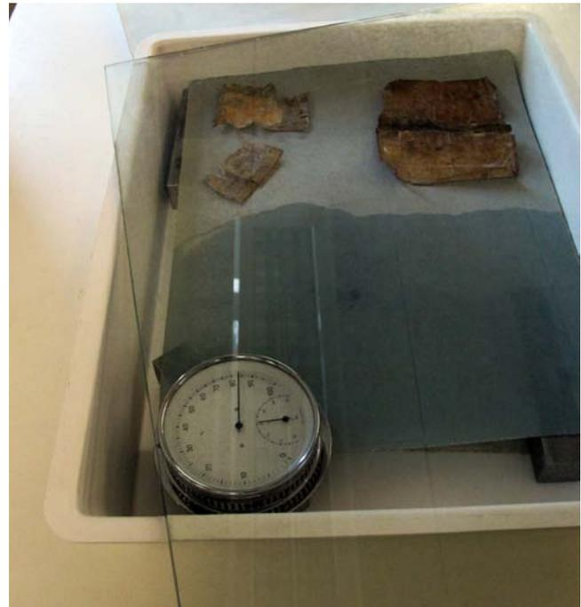
Klimakammer: Schale mit Feuchtigkeitsspender, Hygrometer und Glasdeckel
