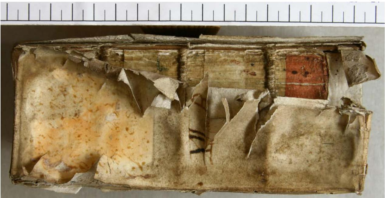
*Vorzustand: Das Pergament ist sehr dünn und spröde. Es weist zahlreiche Risse und Fehlstellen auf. Das Material ist leicht geschrumpft und reicht daher nicht mehr in beide Gelenke. Zur Restaurierung wurden die zum grossen Teil durchgerissenen Gelenke vollständig durchgetrennt.*
