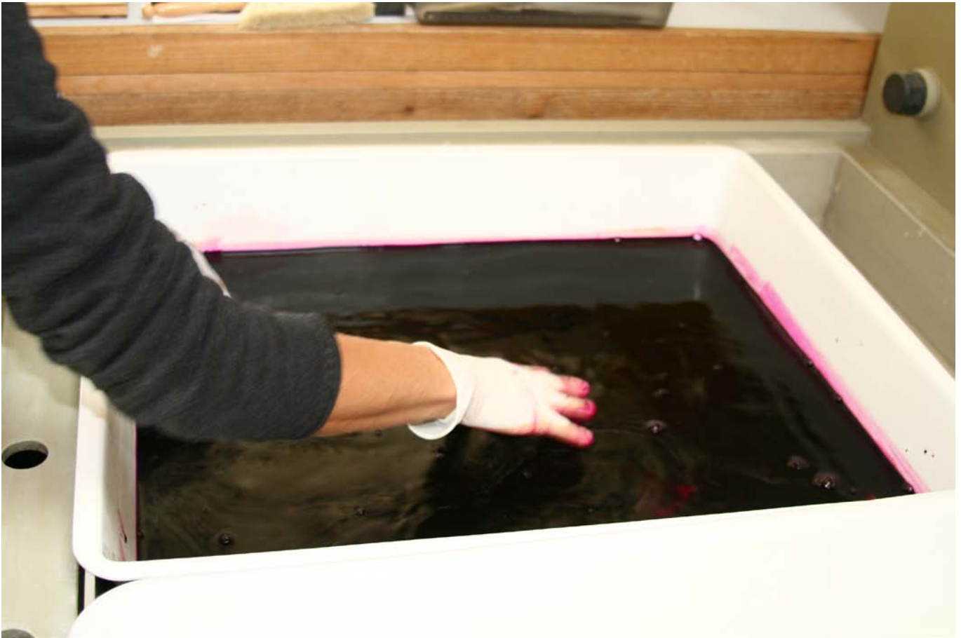
vorher: Das Blatt wird während 10 Minuten gebleicht ( 1\% \text{KMnO}_4 ).
