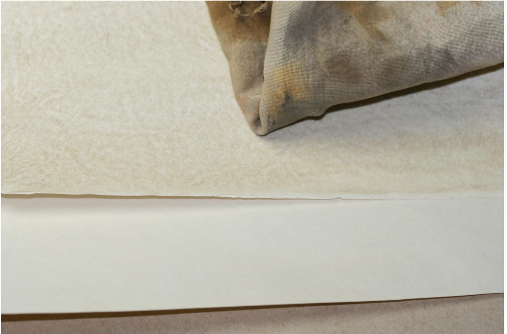
Hier wird das gekalkte Pergament (rote Pfeile) für die runde Rückenform vorbereitet, indem es zwischen Hollytex in die Rundung eines Holzklotzes gepresst und mit Bleisäckchen (grüner Pfeil) beschwert wird.
