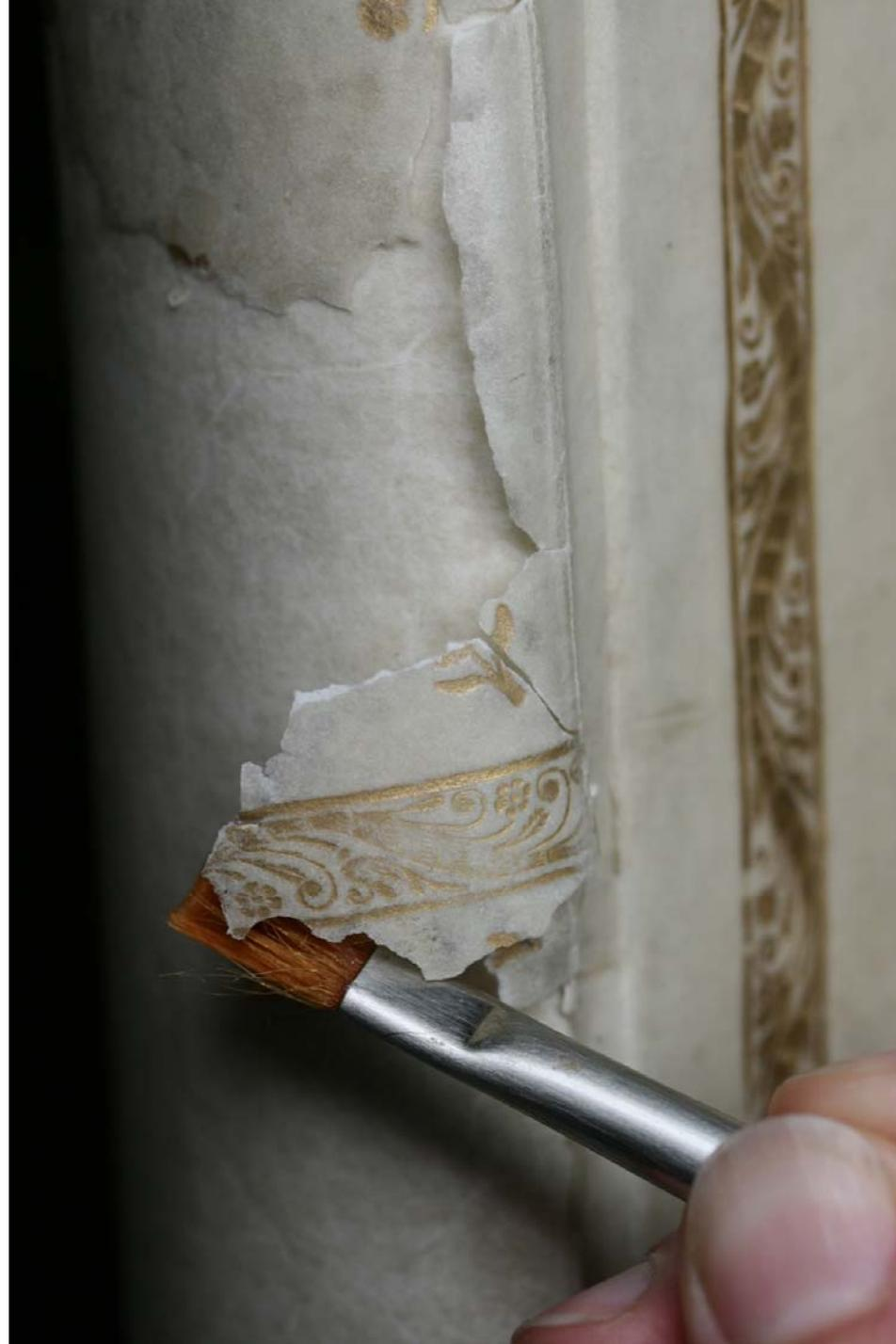
Der neue Rücken ist an die Deckel geklebt. Dieses Foto zeigt den Zustand vor dem Herunterkleben der einzelnen originalen Rückenbezugfragmente.
